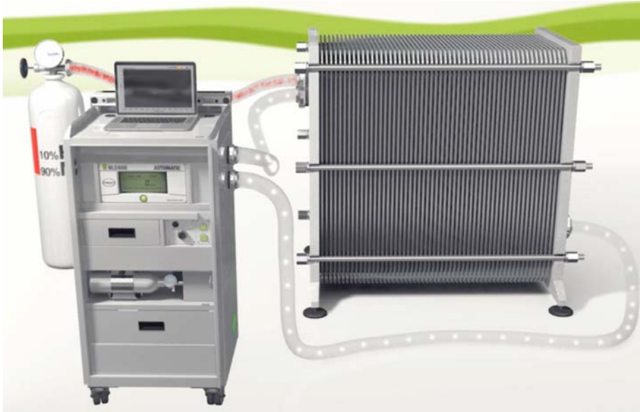
Abbildung 9 - Prüfaufbau bei der Plattenprüfung
