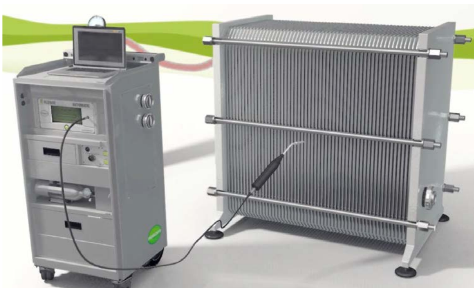
Abbildung 10 - Prüfaufbau bei der Dichtungsprüfung
