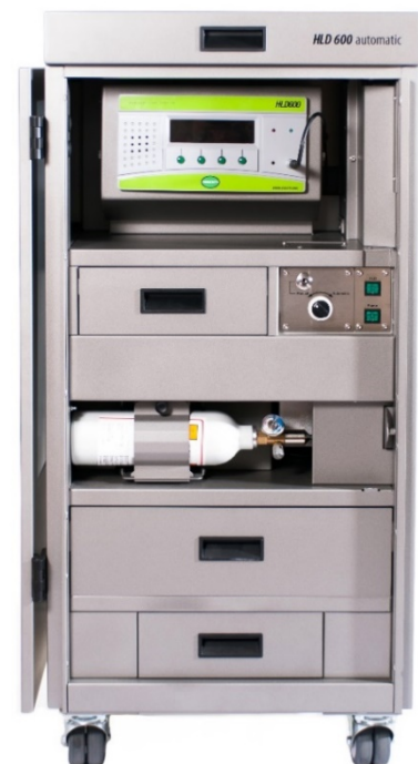
Abbildung 6 - Resom HLD600automatic Wasserstofflecksuchgerät
