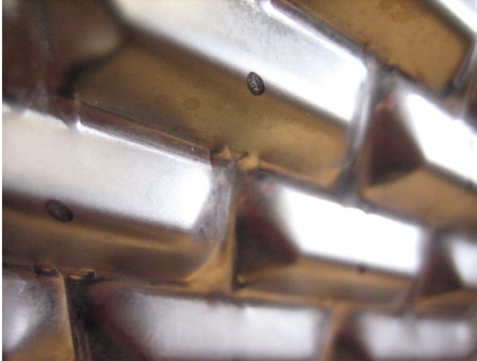
Abbildung 12 - Kontaktkorrosion an den Abstützungspunkten durch Resonanzen im Plattenpaket
